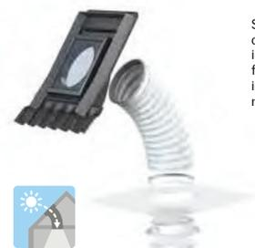
Si la structure du toit est trop complexe pour un tube rigide, il est possible d'utiliser un tube flexible. La longueur d'une installation avec un tube flexible ne doit pas dépasser 2 m.
